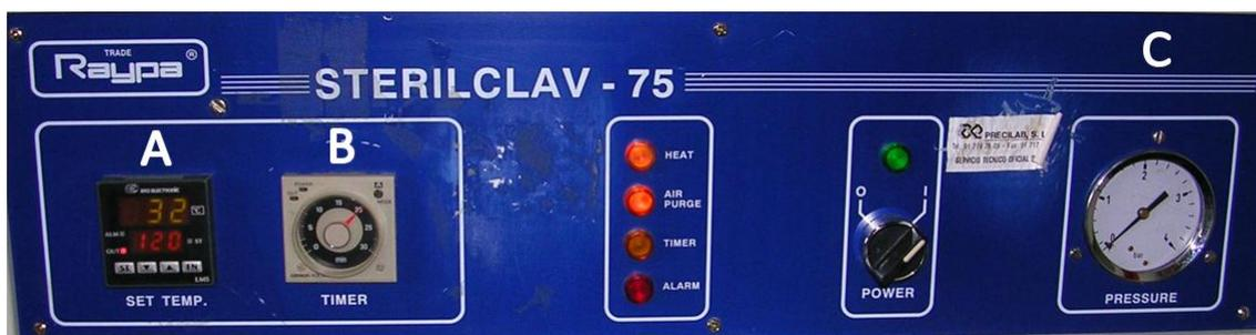
Figura 2. Controles de temperatura (A), tiempo (B) y presión (C) en un autoclave actual.
