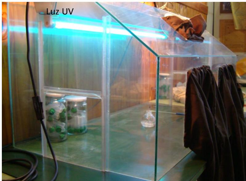
Figura 6-. Cámara de siembra con luz UV para mantener estéril el interior.
