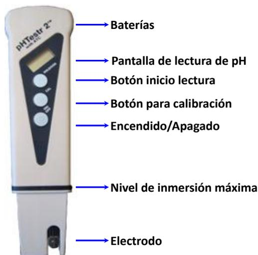
Figura 2. Imagen de un pHmetro portátil.
