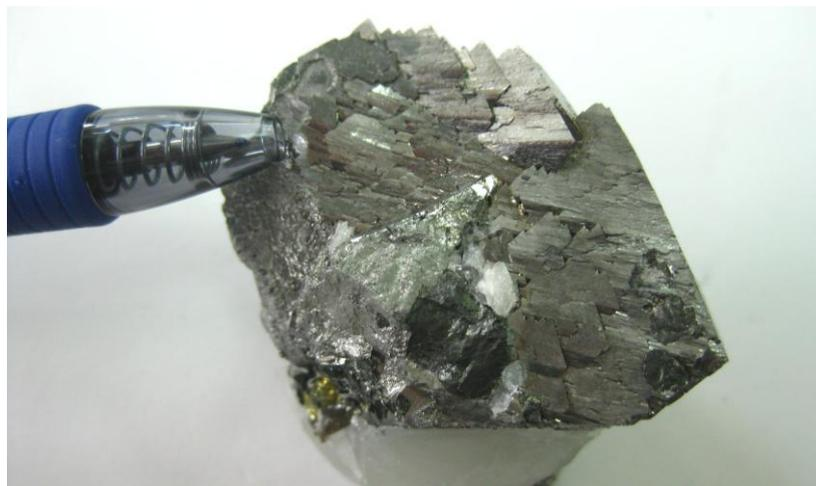
Figura 3. Arsenopirita de color plata con caras estriadas, brillo metálico y maclas en punta de lanza.
